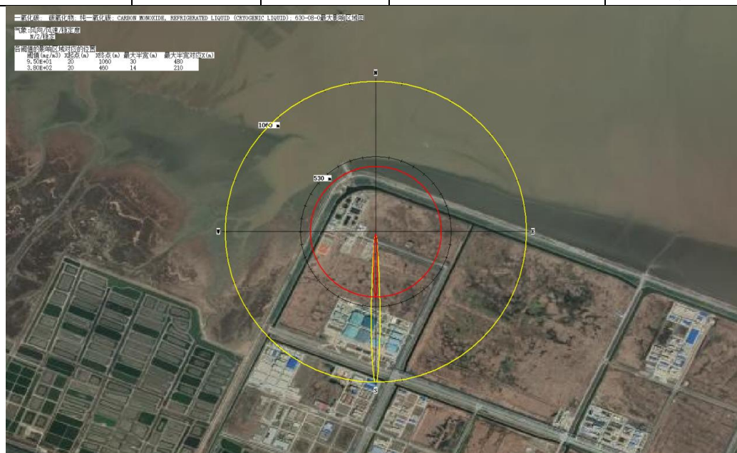
图 6.8-2 预测场景下 CO 浓度达到大气毒性终点浓度的最大影响范围 在最不利气象条件下，各关心点 CO 浓度对应的超标时段及持续超标时间
